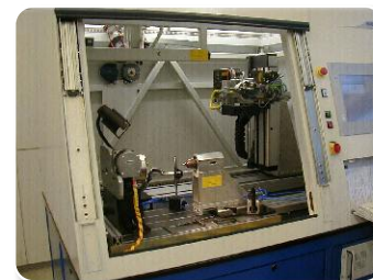
Laser welding „bellows to end parts“
